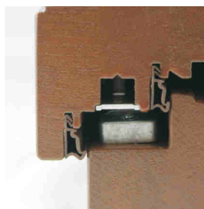
Beschlagfalz: 30 mm Beschlagachse: 13 mm 2 Dichtungsebenen
